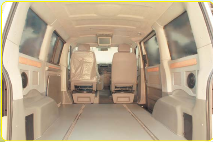
Acabado interior VW Transporter T5, con suelo en Madera Okume con Tarabus y guías correderas, panelado de laterales en ABS, tapizado de techo
