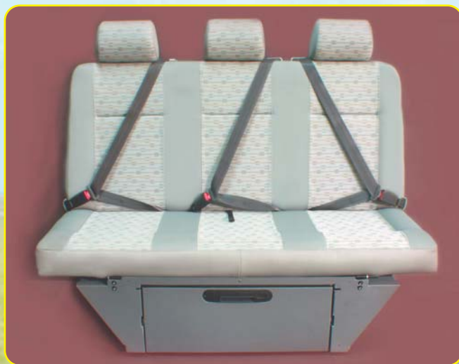
Vista frontal asiento cama 3 plazas deslizable con homologación M1, cinturones 3 puntos, reposacabezas abatibles y cajón extraíble frontal.
