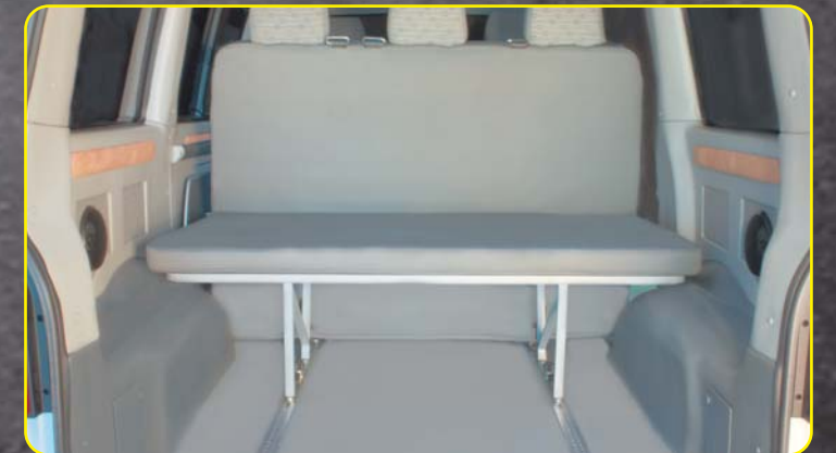
Vista posterior asiento cama recogido y suplemento cama por guías corredera
