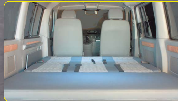
Vista trasera acabado interior, suplemento asiento cama y asiento desplegado.
