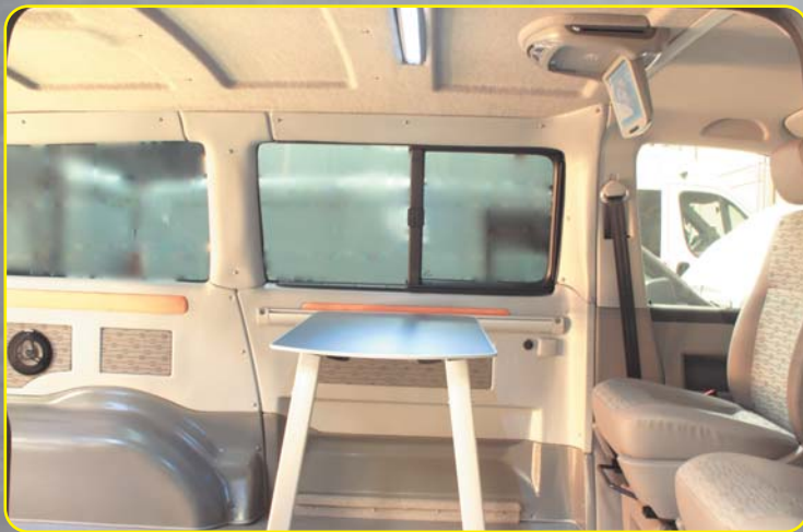
Acabado interior con pantalla DVD, mesa plegable y plafón de leds
