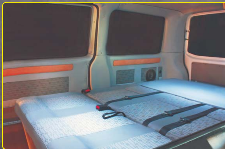
Acabado interior con asiento cama desplegado y suplemento, quedando medida de cama: Ancho 1,45 - Largo: 1,90
