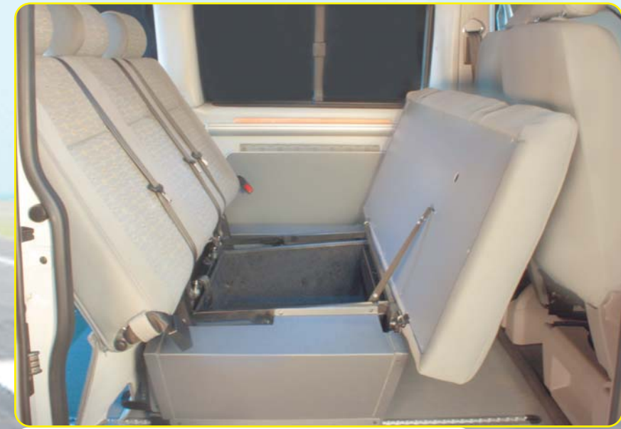
Asiento cama con acceso superior a cajón deslizante
