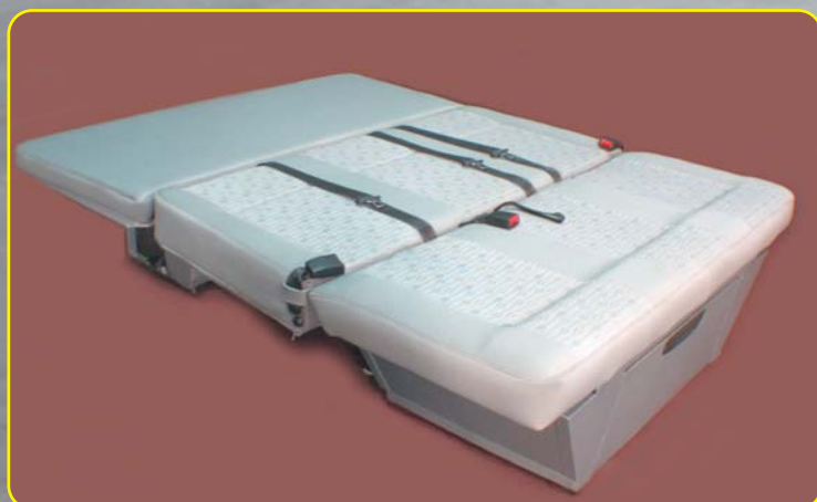
Detalle de asiento cama desplegado y suplemento
