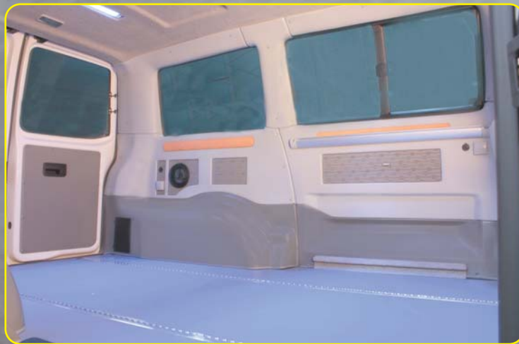
Acabado interior paneles laterales, tapizado techo, suelo y guías correderas
