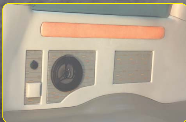
Detalle panel lateral con tomas de 12v y 220v, altavoces traseros y acabado de molduras
